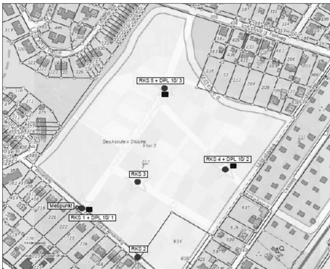
Abbildung 3: Markierung der Bohrpunkte, Geotechnischer Bericht, 2017
